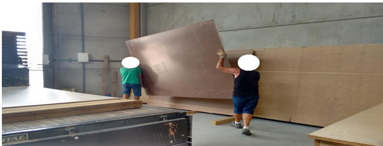
Figura 03 - Carregamento Do Material, com risco de levantamento e transporte manual de peso.
